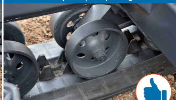
2 rulli per asse, 4 rulli per triangolo
