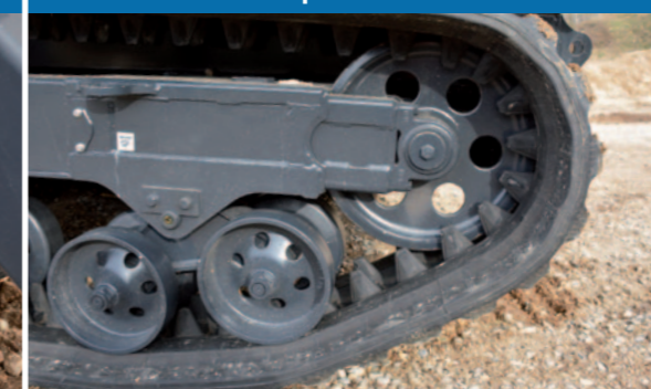
Ruota folle "posteriore" in fusione
