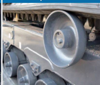
Rullo superiore in fusione
