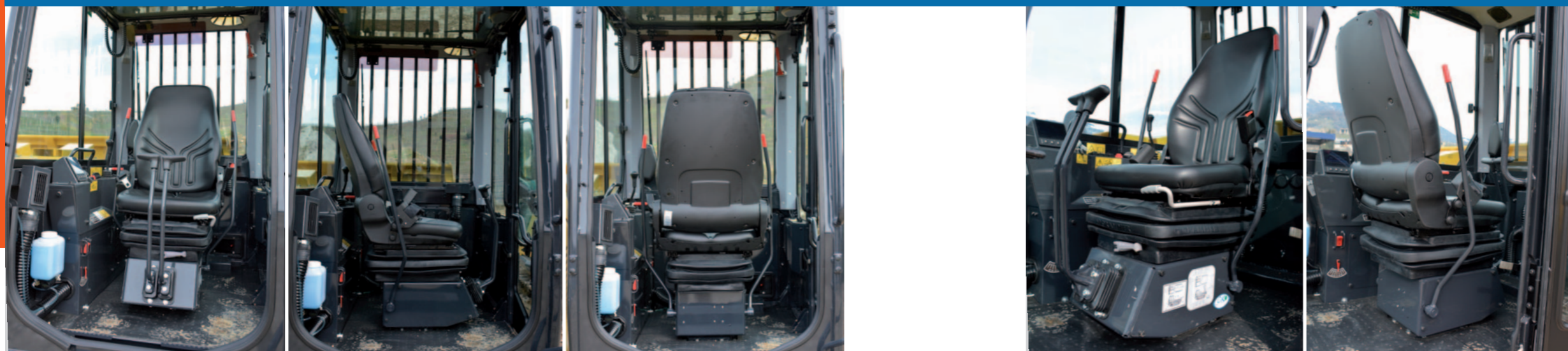
LA POSTAZIONE DI GUIDA RUOTA DI 180° ED È SOLIDARE ALLE LEVE DI TRASLAZIONE
